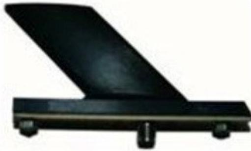
**Figura 2.3. Antena de telemetría de un monoplaza [C]**
