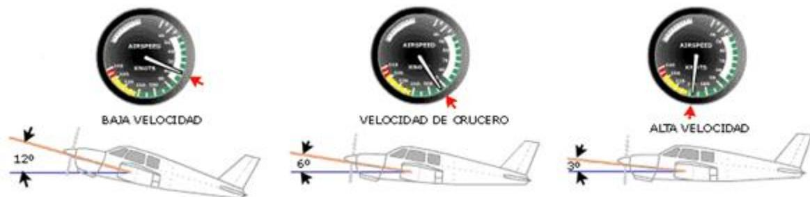
Figura 21. Relación entre ángulo de ataque y velocidad en vuelo recto y nivelado
