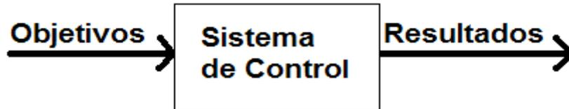
Figura 23. Componentes básicos de un sistema de control.
