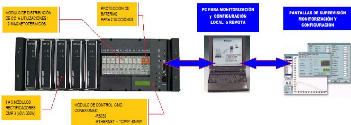
Figura 47 Arquitectura de rectificadores
