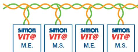
Figura 31. Ejemplo de conexión mediante Red Bus
