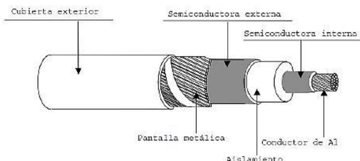
El conductor estará constituido por un elemento circular compacto de clase 2 según la norma UNE 21 022, de aluminio.
