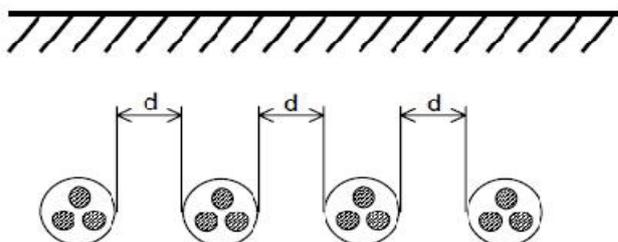
Al transcurrir por una misma zanja 4 ternos de cables unipolares en el caso más desfavorable, distanciadas entre sí 0.1 m, aplicaremos de acuerdo con la tabla 10 del Reglamento de Líneas de Alta Tensión ITC-LAT 06 un factor de corrección de 0.63, por tanto la intensidad a considerar, en el caso de la alimentación por uno de los extremos será:
