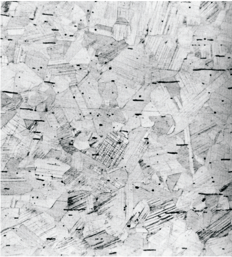
FIGURA 2. CYRIL STANLEY SMNITH. MICROGRAFÍA MOSTRANDO LA ESTRUCTURA DE UNA ARMADURA DE ACERO CRETENSE (ALREDEDOR DE 600 A.C.).
