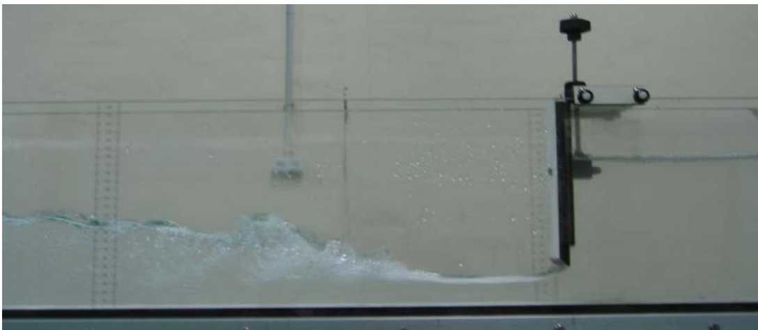
Fotografía 7. Resalto hidráulico libre estabilizado a 14 cm de la compuerta
