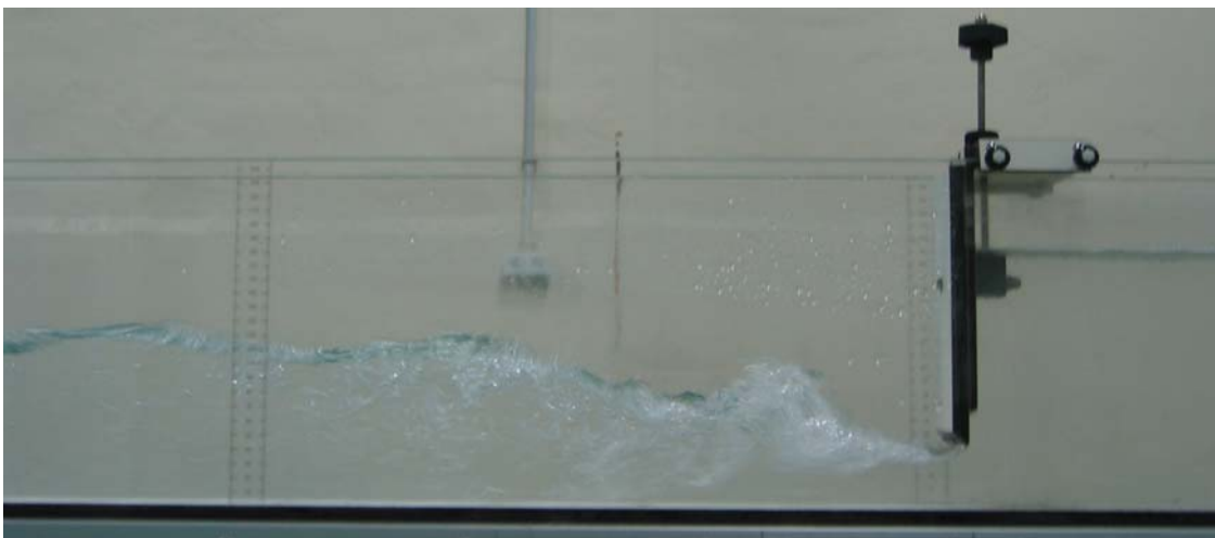
Fotografía 8. Resalto hidráulico libre al pie de la compuerta
