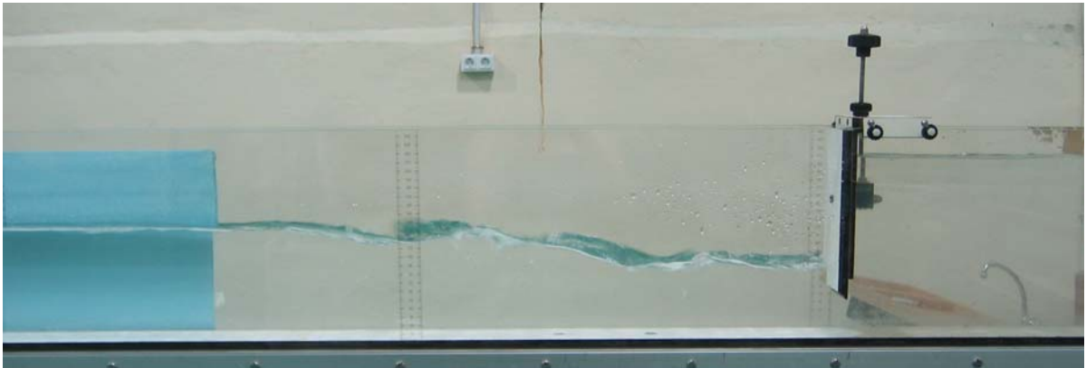
Fotografía 9. Resalto hidráulico sumergido
