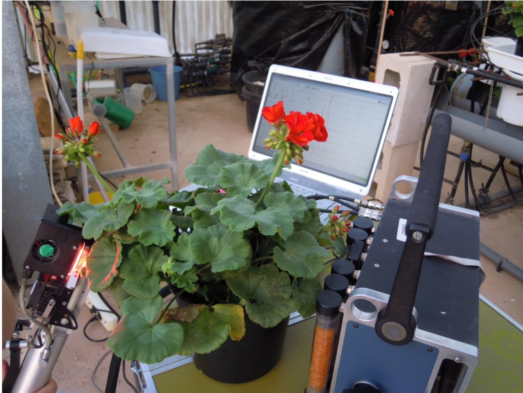
Foto 15: Detalle de la medición del intercambio gaseoso
