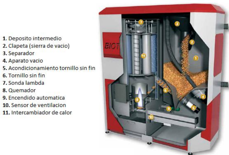
Figura 3.4. Partes de una caldera de biomasa
