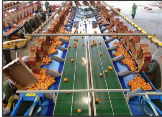
Figura 3: Detalle mesa de confección de empaquetado frontal.
