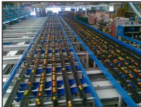
Figura 4: Detalle de un calibrador electrónico universal.
