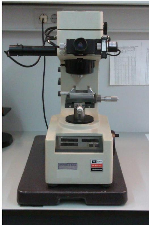
*Figura n° 3.9.- Durómetro LECO M400G1.*
