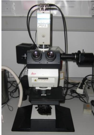
*Figura n° 3.6.- Microscopio óptico Leica DMR.*
