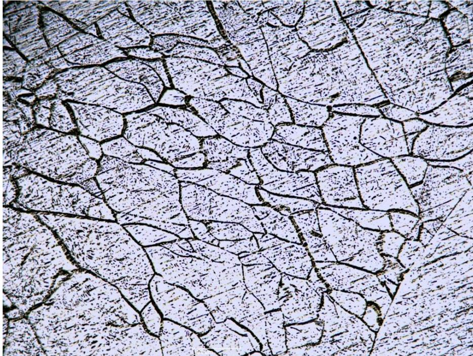
*Figura n° 3.15.- Microestructura de la aleación Ti11,84Mo.*
