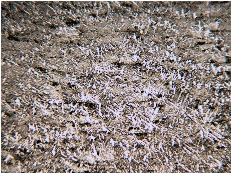
*Figura n° 3.14.- Microestructura de la aleación Ti11,08Mo.*
