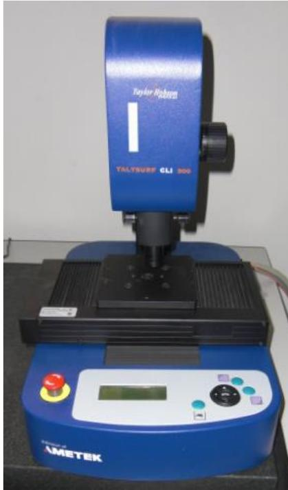
*Figura n° 3.5.- Perfilómetro TalySurf Cli 500.*
