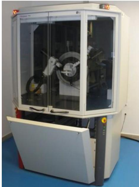
*Figura n° 3.7.- Difractómetro de Rayos X Bruker D8 Advance.*
