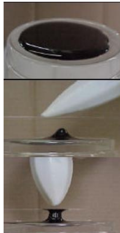
Figura 32. Comportamiento de un ferrofluido con un 21% de magnetita y preparado en aceite comestible.
