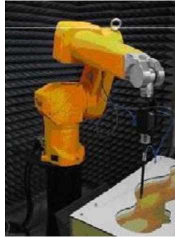
Figura 10. Simulación robotizada de efecto biológico de telefonía móvil. Universidad Politécnica de Cartagena.
