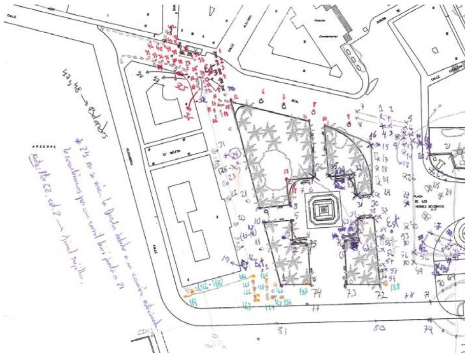
Croquis 4: Este croquis representa los puntos radiados desde las estaciones seis (dos del tercer itinerario; en azul), siete (tres del tercer itinerario; en rojo), diez (seis del tercer itinerario; en azul) y algunos puntos de CIM-1 (en verde).
