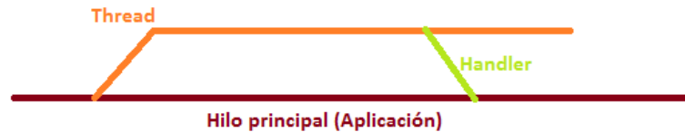
Figura 16: esquema funcionamiento de los "Threads".
