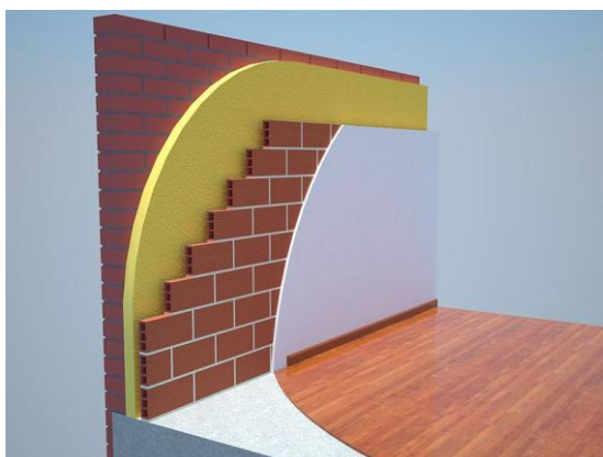
Ilustración 36. Disposición de elementos para aislamiento por el interior con espuma de poliuretano. Fuente: five.es.
