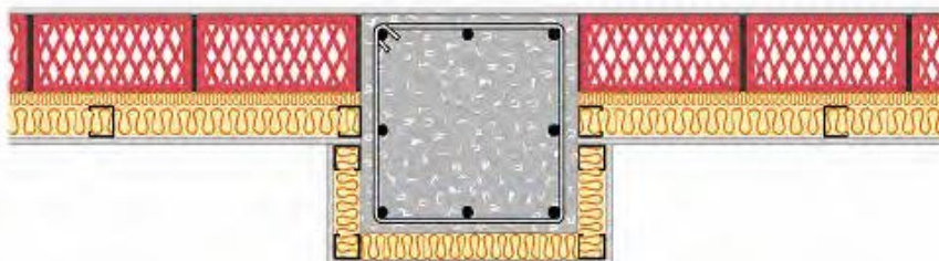
Ilustración 32Detalle constructivo de la intersección de pilares en fachada. Fuente: IDAE.
