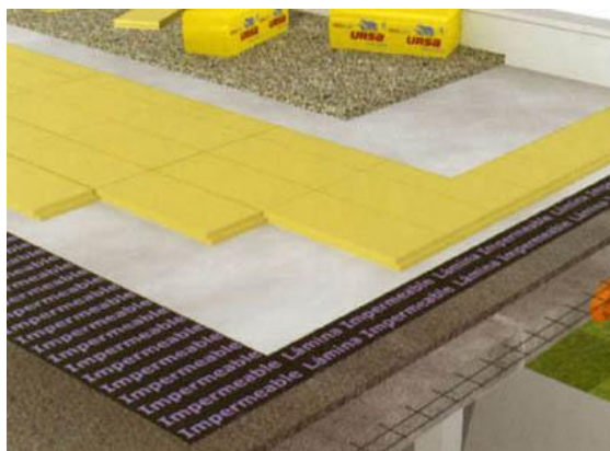
Ilustración 23. Esquema de instalación de aislamiento con XPS para cubierta invertida. Fuente: IDAE, 2010
