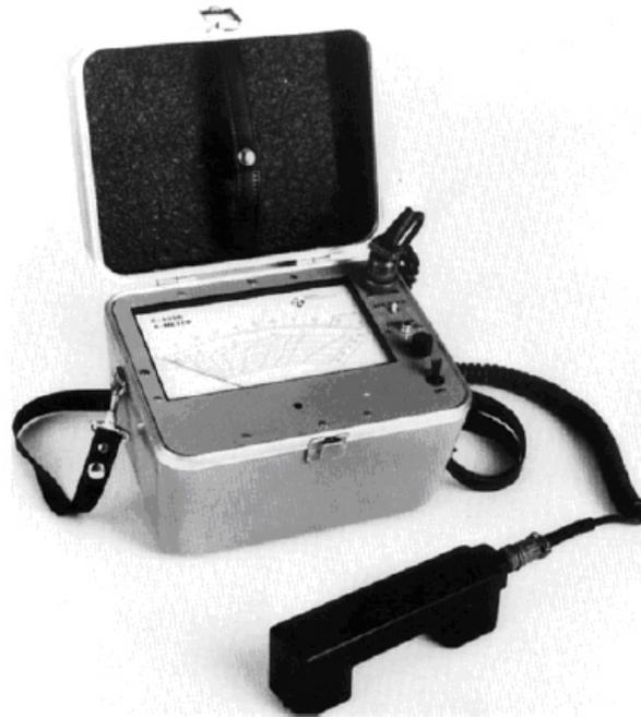
**Fig. 5.3-Pacómetro (localizador de armaduras)**(Fuente de James Instruments)
