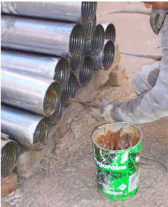
**-FOTO 8. FOTO DE LOS TRAMOS DE ENTUBACIONES QUE SE UTILIZÁN PARA LA PERFORACIÓN. LOS CUALES TIENEN QUE SER LIMPIADOS, Y ENGARASADA SU ROSCA, DESPUES DE CADA UTILIZACIÓN. (Fotografía del Autor)**
