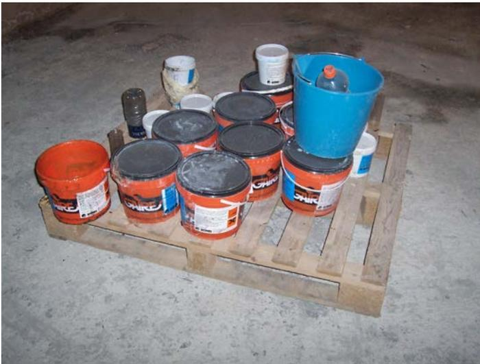
**Foto.- 8.9.** En esta fotografía se puede observar como se encuentra almacenada, de forma paletizada para facilitar el transporte, la resina epoxi, un material muy utilizado en las obras de recalces. *(Foto del Autor)*
