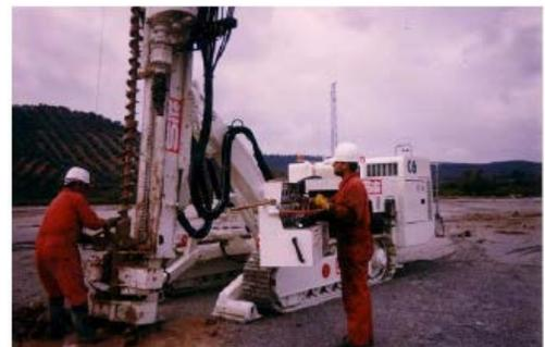
b) Perforación a **roto-percusión**: consiste en triturar los materiales por fricción y percusión. Se pueden utilizar martillo en cabeza (el golpe se realiza desde el exterior mediante martillos percutores) o martillo de fondo (el golpe lo realiza el martillo puesto en la punta del varillaje de perforación accionado por aire comprimido).
