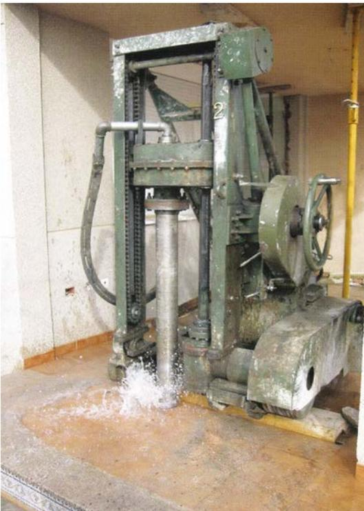
Foto 6.6 – Máquina para micropilotar especialmente en casos de recalces debido a su tamaño reducido
