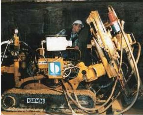
**-FOTO 1. FOTO DE LA MÁQUINA UTILIZADA EN LA EJECUCIÓN DE LOS MICROPILOTES**
