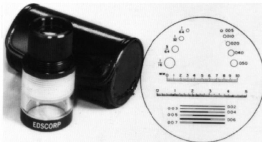
**Fig. 5.1 Comprobador para medir anchos de fisura.** (Fuente de Edmund Scientific Co.)
