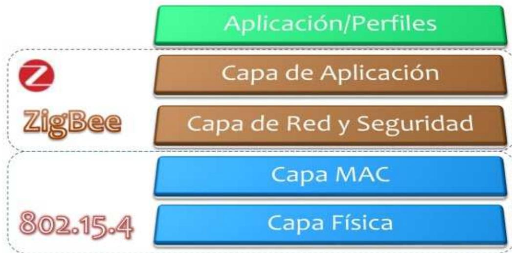
**Figura 3.9:** Diagrama de organización del protocolo ZigBee y 802.15.4 dentro de la capa OSI.
