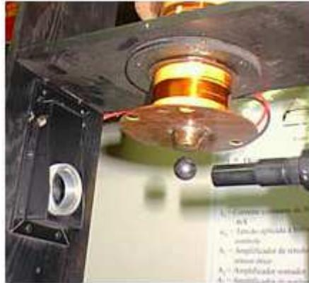
**Figura 2.15:** Funcionamiento del levitador magnético diseñado y construido en el Departamento de Física de la Universidad de Murcia.
