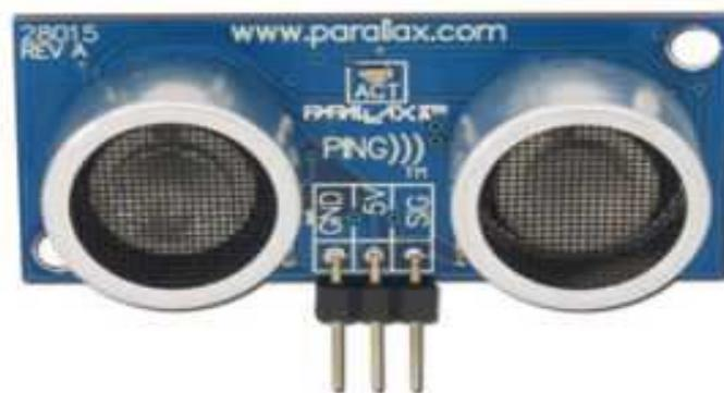
**Figura 4.4:** Sensor de ultrasonidos comercializado por Parallax INC.
