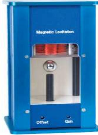
**Figura. 2.11:** Maqueta de levitación magnética comercializada y distribuida por Quanser.
