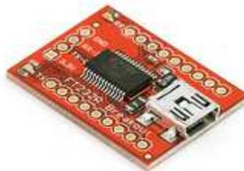
**Figura 5.48:** Vista del Módulo USB FT232RL.
