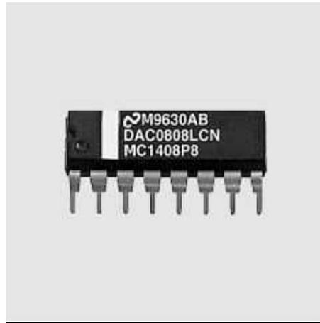
**Figura 5.31:** Imagen del convertidor analógico-digital DAC0808 utilizado.
