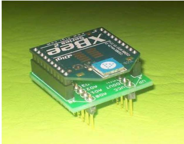
**Figura 5.47:** Modulo Xbee ya montado Xbee Breakout Board.
