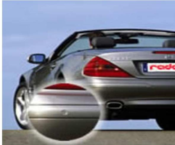
**Figura 4.5:** Aplicación de los sensores de ultrasonidos en la industria automovilística, con el fin de alertar de la distancia de un obstáculo, facilitándole así las maniobras al conductor.
