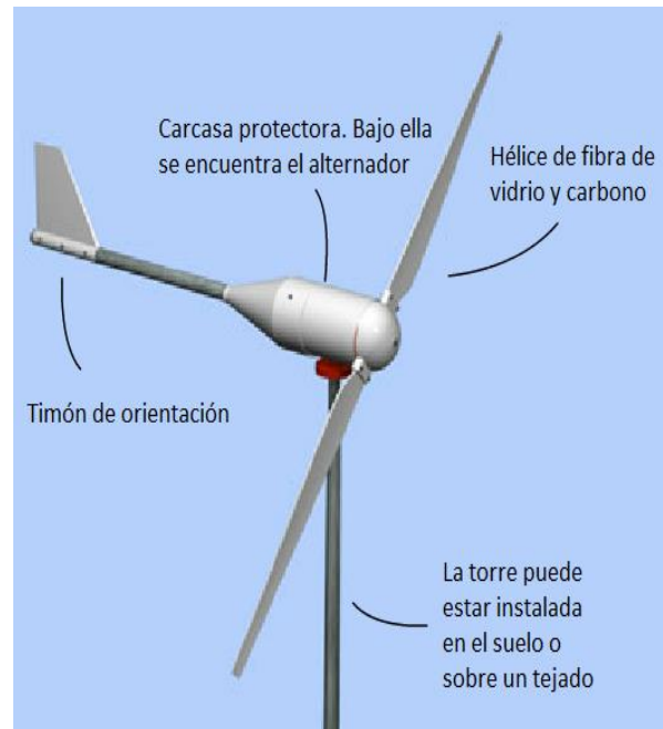
Ilustración 54. Partes de un aerogenerador para energía mini-eólica.
