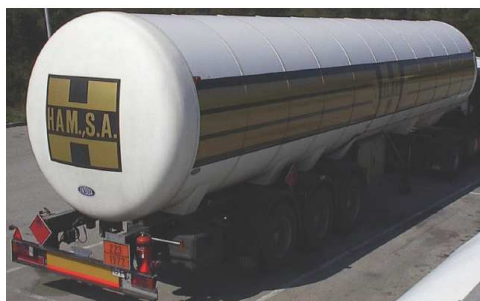
I.8. Camión Cisterna de GNL. 10
