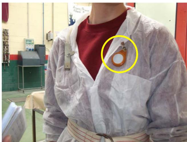
Imagen 17. Disposición de un filtro impregnado en la zona de respiración del trabajador.
