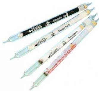
Imagen 9. Tubos colorimétricos marca Dräger Safety.
