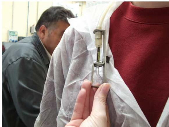
Imagen 19. Tubo con adsorbente sólido colocado en la zona de respiración del trabajador.
