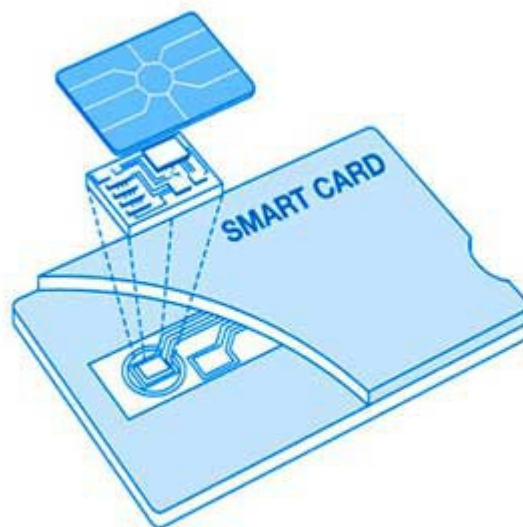
Figura 2.5. Arquitectura de una Smartcard
