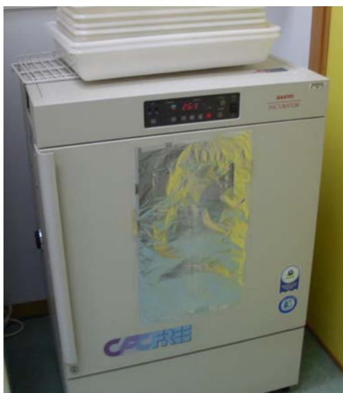
**Figura 5.10.** Incubadora programada a 26°C, dotada de ventilador y en oscuridad.
