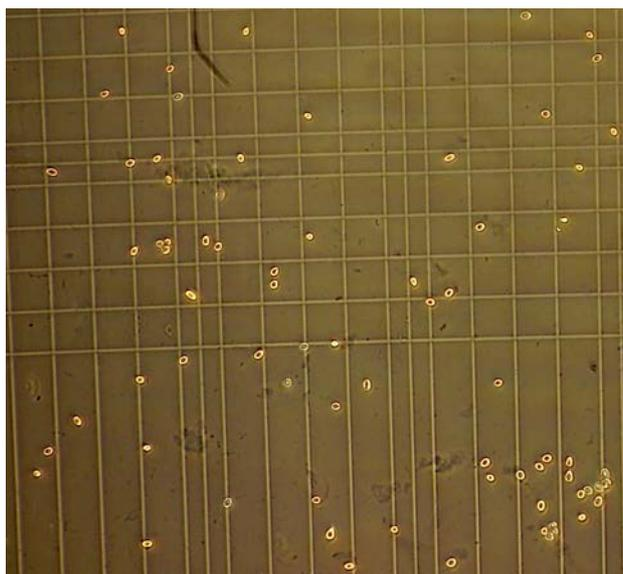
**Figura 6.6.** Detalle de la cámara de recuento Thoma con conidios de *Botrytis cinerea* bajo el microscopio de contraste de fases.
