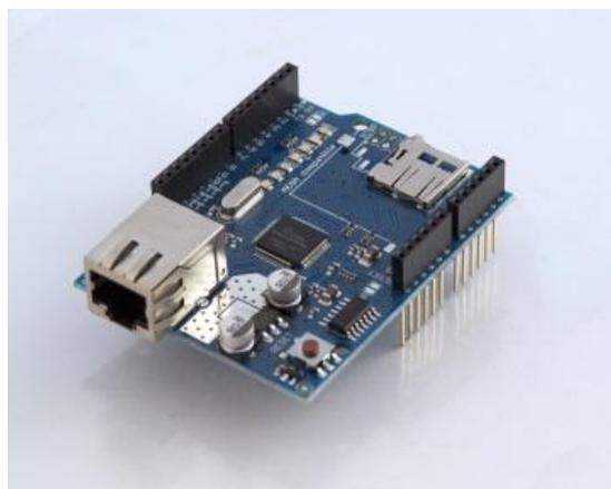
Ilustración 2-15: Arduino Ethernet Shield.
