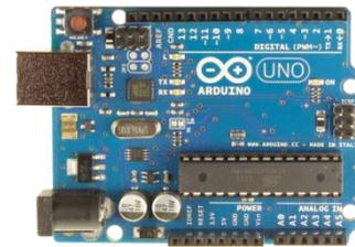
Ilustración 2-14: Placa Arduino UNO
