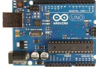
Ilustración 3-18: Vista Conjunta Arduino UNO
