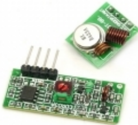
Figura 4.24. Módulos Rx y Tx. Modelo WLS107B4B.
