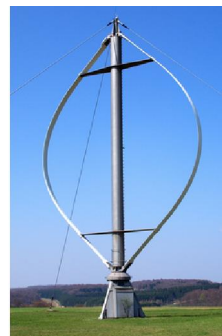
Figura 32 – Aerogeneradores de eje vertical. (a): Savonius. (b): Darrieus
