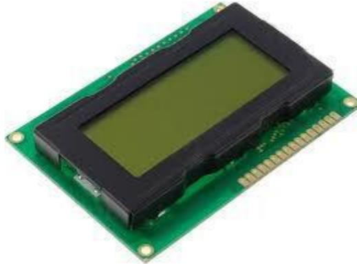
En este proyecto utilizaremos una pantalla LCD 4x16 retroiluminada. Esta contiene un módulo microcontrolado capaz de representar 4 líneas de 16 caracteres cada una. Para el control de esta pantalla se utilizará un microcontrolador que nos permitirá mostrar por pantalla el estado de nuestro sistema.
