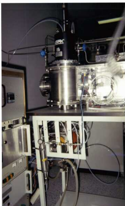
Figura 1. Fotografía del sistema de ECR-CVD. En la parte superior: cámara de ionización, en el centro: cámara de depósito, debajo de la mesa: bomba de vacío turbomolecular.
