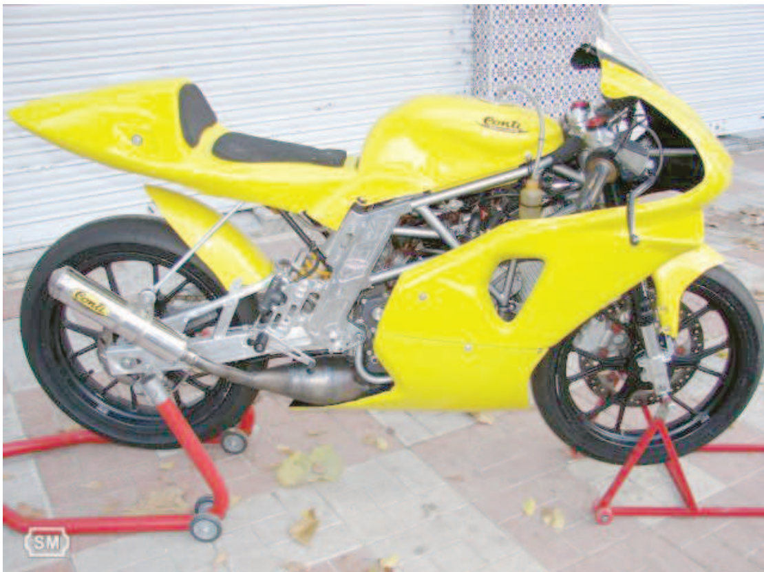
Figura 3.8 Ejemplo de chasis mixto, Conti PreGP
