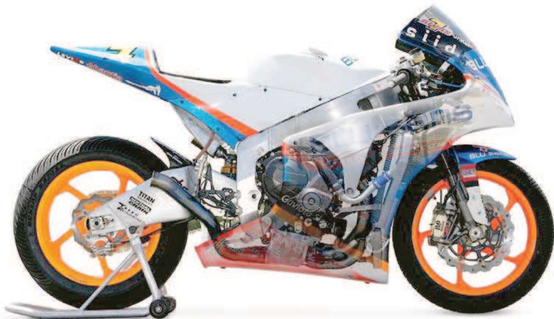
Figura 3.9 Ejemplo de chasis doble viga, BQR
