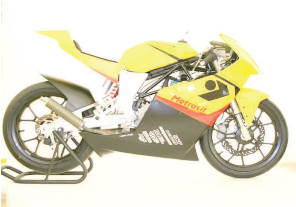
Figura 3.7 Ejemplo de chasis mixto, Metakit PreGP
