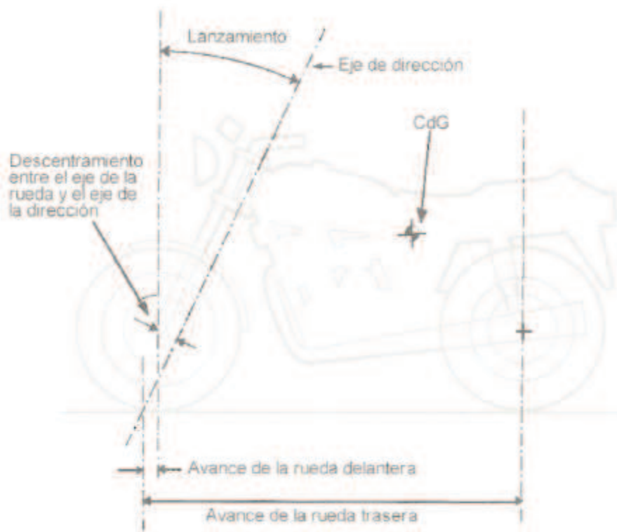
Figura 2.3 El eje de dirección es la línea sobre la cual gira el sistema de dirección.
