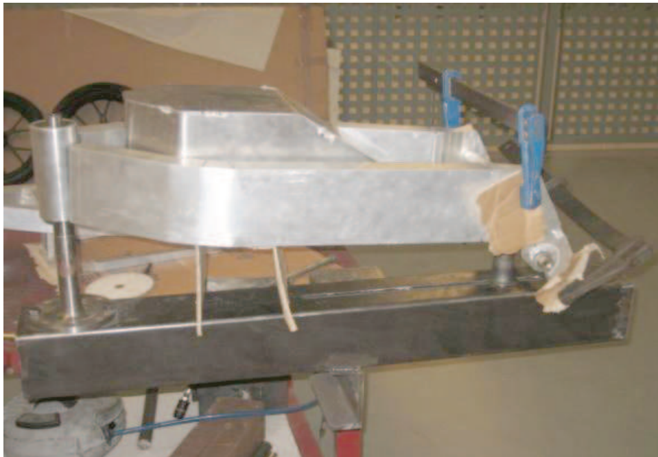
Figura 6.9 Chasis MotoUPCT en proceso de soldadura
