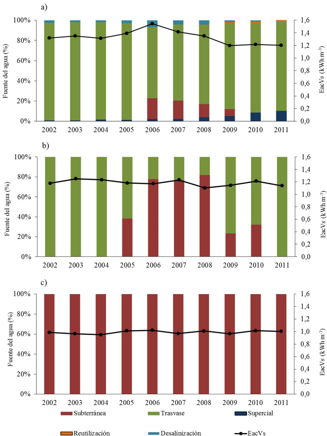
Figura 4.2. Evolución de las fuentes de agua y la energía específica (EacVs) por CCRRs en el periodo estudiado. a) CRCC; b) CRTCC; c) CRM.
