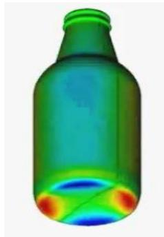
Ilustración 16: Análisis termo-mecánico de un envase de vidrio
