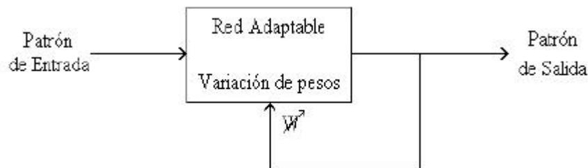
**Figura 3.5** Diagrama esquemático de un sistema no supervisado.
