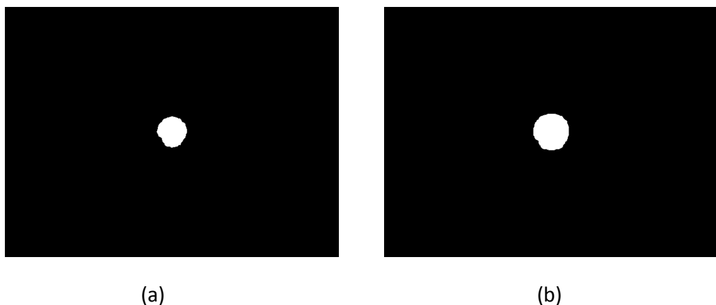
Fig. 7.14.- Aplicación de apertura a la imagen: (a) Aplicación del proceso de erosión. (b) Aplicación del proceso de dilatación.
