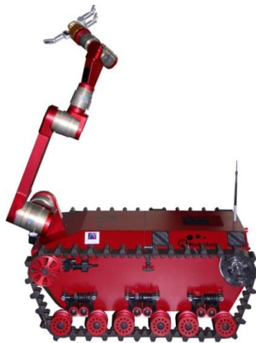
Fig. 3.2- Plataforma móvil con un brazo Robotnik montado.
