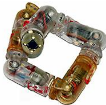
Fig. 2.4- Robot con la forma y movimientos de un gusano.
