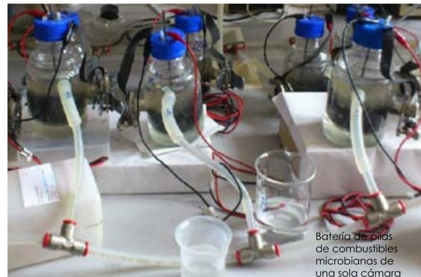
Batería de pilas de combustibles microbianas de una sola cámara
