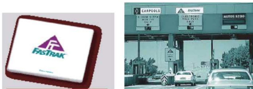
Figura 21: Tag y cabina de peaje de un sistema de peaje automático FasTrak
