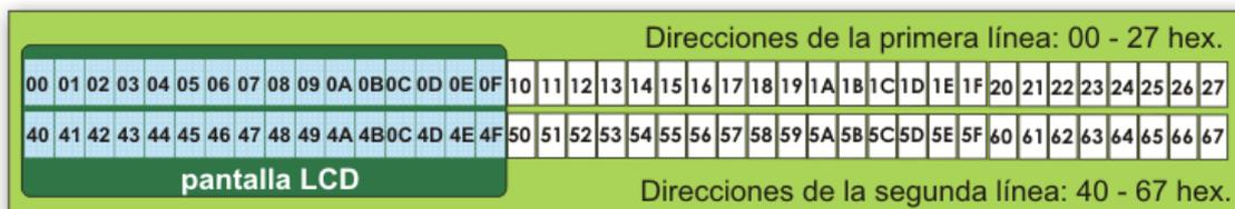
Ilustración 14: Tabla de direcciones de la DDRAM en la LCD
