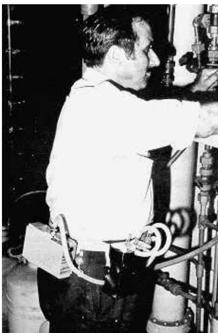
Se conectan dos impingers, provistos de borboteador normal, en serie; conteniendo cada uno de ellos 15 ml de solución absorbente y se utiliza un impinger vacío como trampa, colocado en serie mediante tubo flexible de silicona con los dos impingers de captación, e intercalado entre éstos y la bomba, para protección de ésta.
