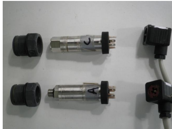
Figura 3.7. Transductores de presión con sus conectores eléctricos y adaptadores de PVC.
