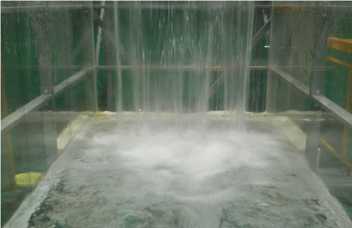
Figura 4.6. Imagen de chorro rectangular tubificado justo antes del impacto en la solera.
