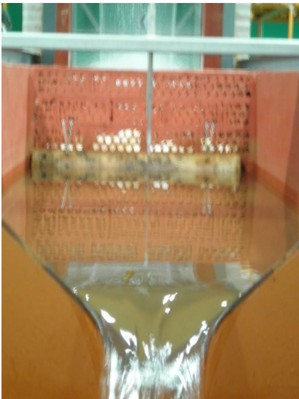
Figura 3.3. Vertedero triangular desaguando, con limnómetro al fondo.
