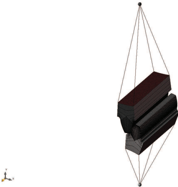
Figura 4.5.3: Representación del modelo de elementos finitos de una pareja de dientes en contacto en IGD.
