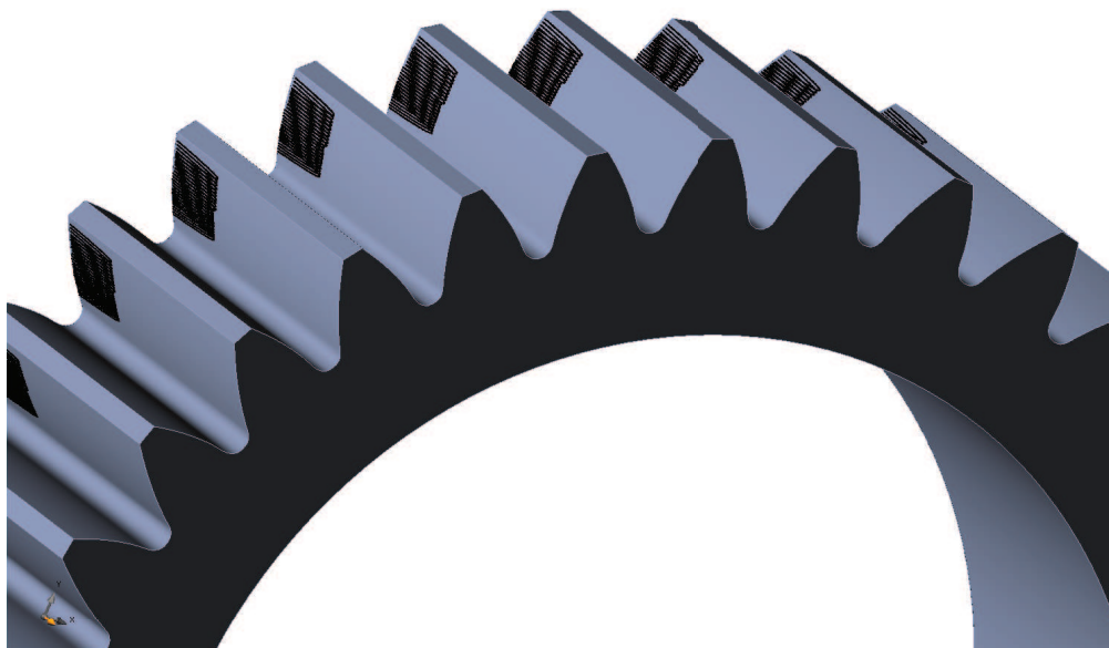
Figura 4.4.8: Patrón de contacto sobre las superficies de los dientes de la rueda en condiciones de desalineación.
