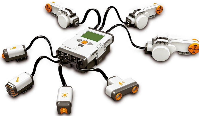
Imagen 3.1 NXTBrick con Sensores y Servomotores conectados
