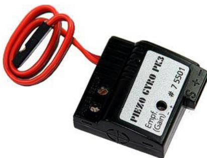
Imagen 3.15 Giróscopo electrónico piezoeléctrico
