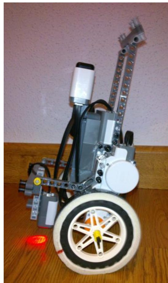
Imagen 3.13.1 Vista disposición sensor de luz en posición vertical y durante oscilación.
