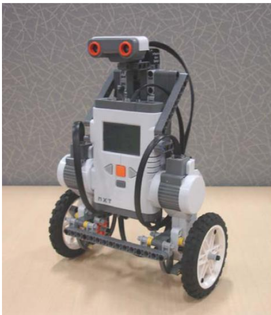
Imagen 1.2 Robot con configuración Segway.
