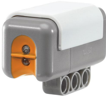
Imagen 3.12 Vista exterior sensor de luz con diodo emisor y receptor
