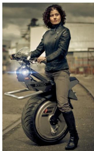
Imagen 7.2 Monociclo autoestabilizado para transporte unipersonal
