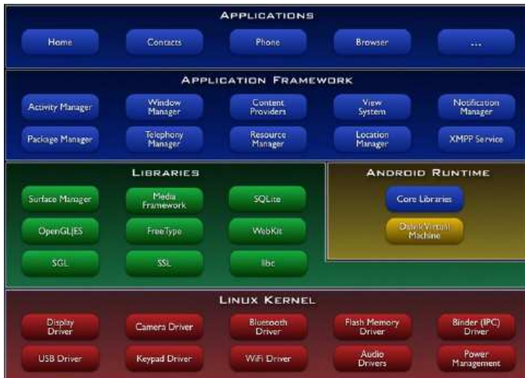
Figura 14. Las diferentes capas que conforman el sistema operativo Android.
