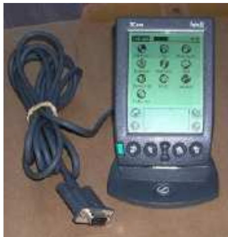
Figura 5. Dispositivo PDA, modelo Palm III de 1999, desarrollado por Palm Computing. Pantalla táctil LCD con 4 tonos de gris, 8 MB de memoria RAM. La imagen muestra el dispositivo acoplado a su base de conexión al PC.
