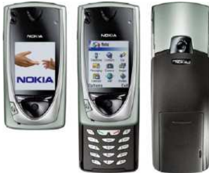
Figura 10. Teléfono móvil Nokia 7650 (2002). Con Symbian OS 6.1 y 3,6 MB de espacio adicional, permitían instalar aplicaciones como por ejemplo una versión del navegador Opera.
