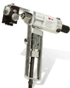
Imagen 5.6.11. Modelo de pistola para pequeñas aplicaciones de poliuretano.
