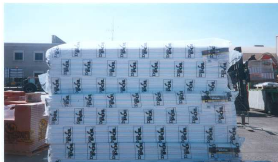
Imágenes 4.1.1. y 4.1.2. Planchas de XPS y EPS con su embalaje plástico, apiladas en almacén de materiales.
