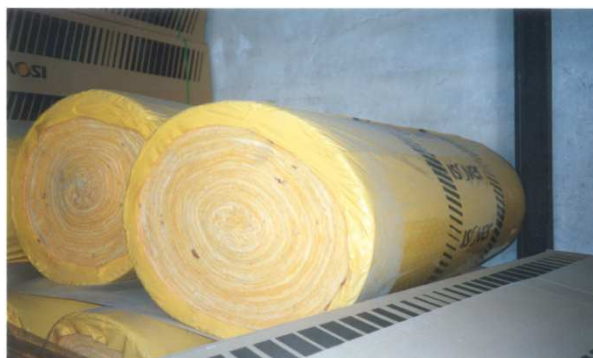
Imagen 4.3.1. Rollos de manta de lana de vidrio, con su embalaje plástico, en almacén de materiales.
