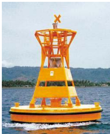
Figura 26: Boya de medición de la elevación de la superficie marina.
