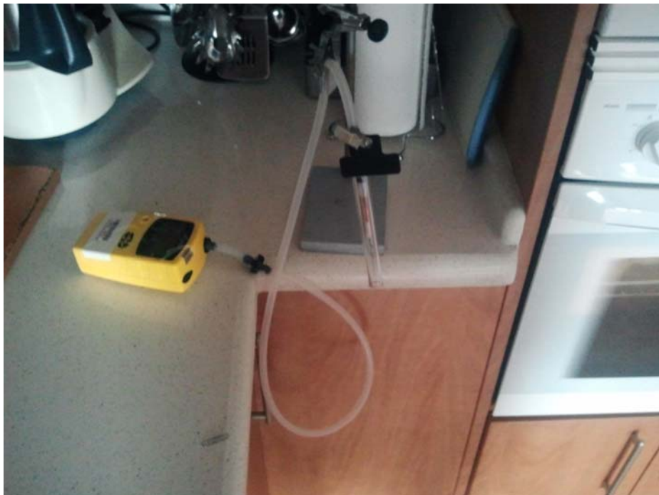
Figura III.2. Dispositivo preparado para la toma de muestra durante el cocinado.
