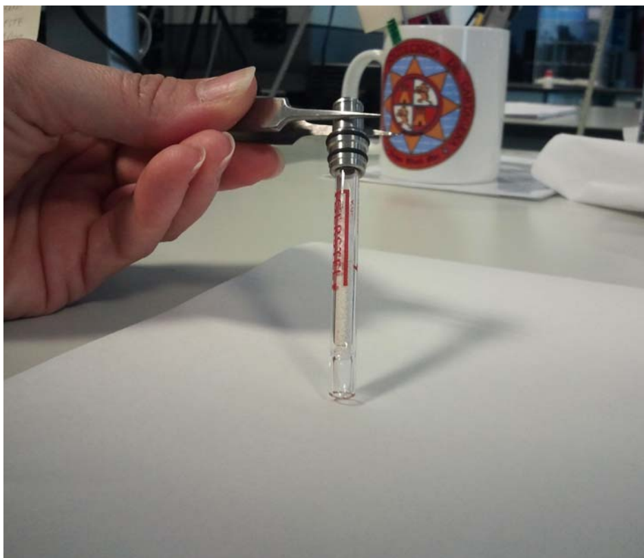
Figura III.4. Adsorbente Tenax preparado para su uso en un tubo de transporte.
