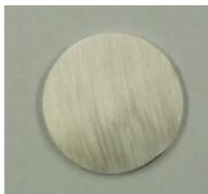
**Figura 42:** Probeta utilizada para los ensayos electroquímicos
