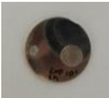
Figura 93: Probeta de MgAZ31B con LMP101
