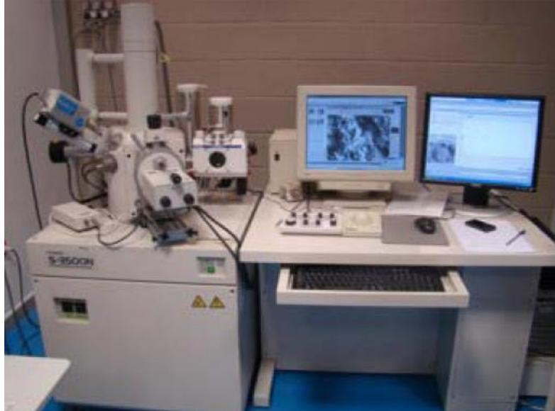
**Figura 24:** Microscopio electrónico de barrido Hitachi S-3500N
