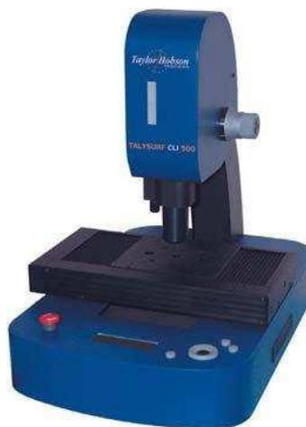
Figura 15: Perfilómetro de no contacto
