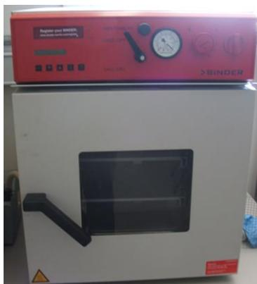
Figura 17: Horno de vacío
