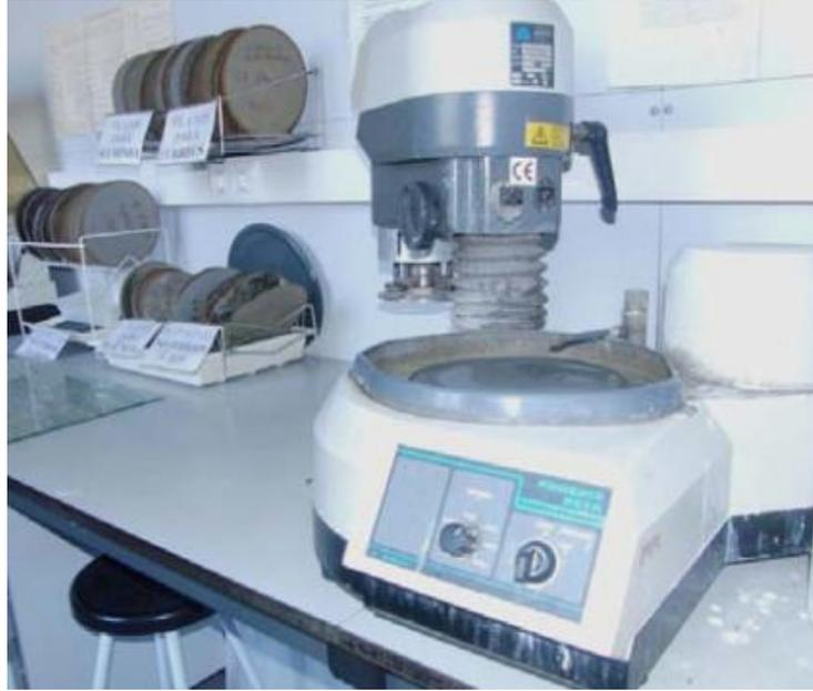
**Figura 10:** Pulidora metalográfica
