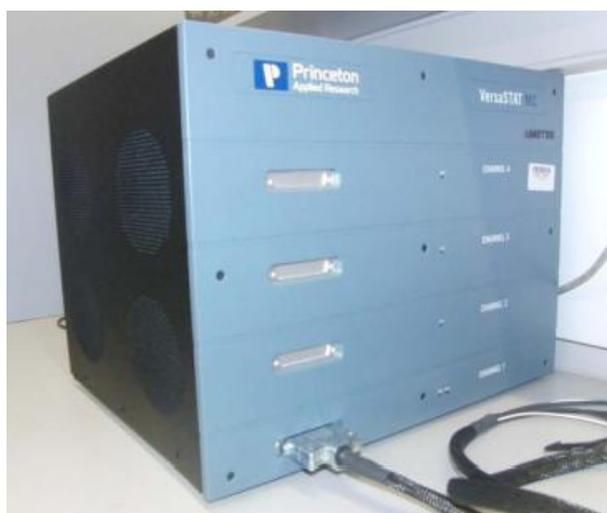
**Figura 18:** Potenciostato/Galvanostato VersaSTUDIO MC.
