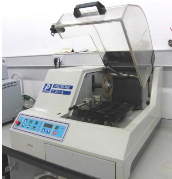
**Figura 9:** Cortadora de precisión
