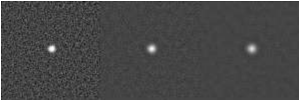
Ilustración 40. Comparación del efecto del parámetro de regularización, de izquierda a derecha se aumenta el parámetro
