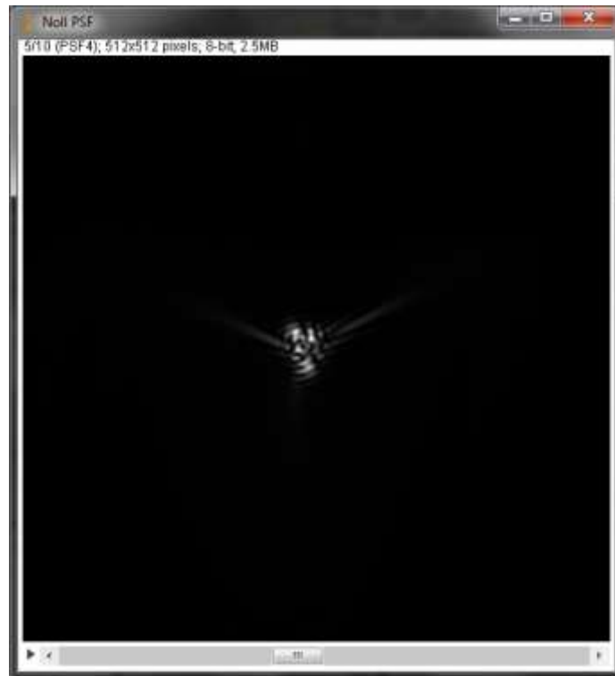
Ilustración 19. Ejemplo de una PSF generada con el modelo de Noll
