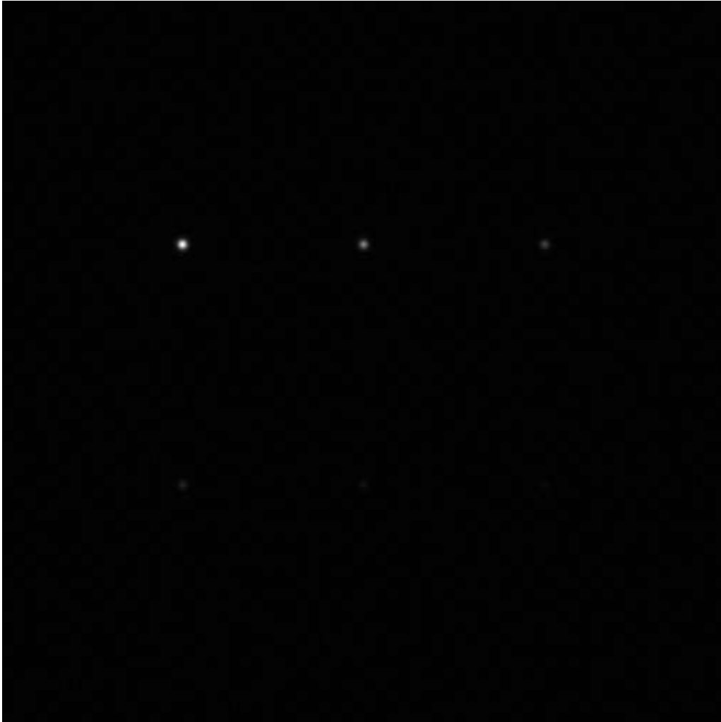
Ilustración 78. Caso Wiener con premediado en modelo atmosférico de 1000 muestras. ( \gamma = 4 \cdot 10^6 )
