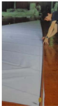
**Ilustración 110: el grátil se corta en una curva limpia.**
