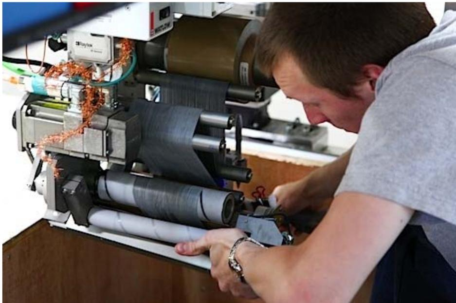
**Ilustración 143: cabezal aplica cintas**
