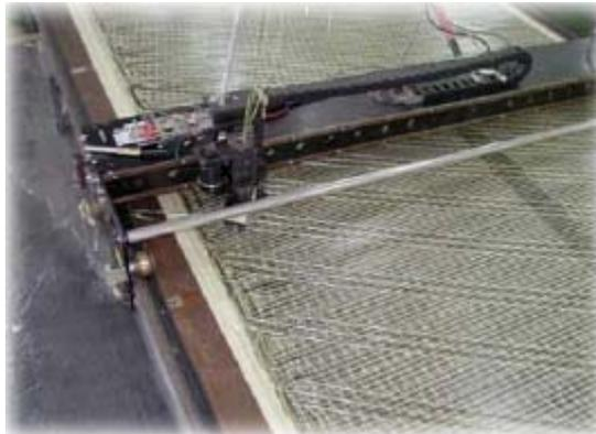
**Ilustración 131: colocación de las fibras sobre mesa plana mediante sistema de plotter**
