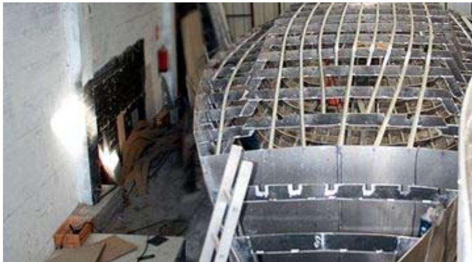
**Ilustración 43: longitudinales de cubierta.**
