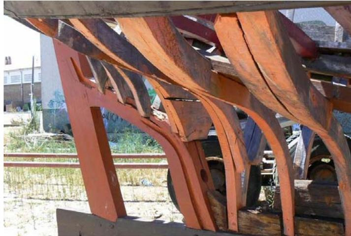
**Ilustración 19: codaste de una pieza**
