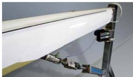
**Ilustración 92: test trapa de botavara**
