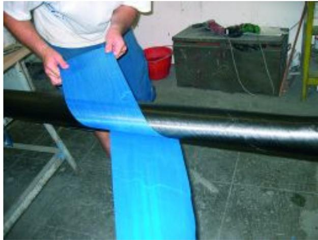
**Ilustración 89: Operario colocando fibra carbono en molde macho**
