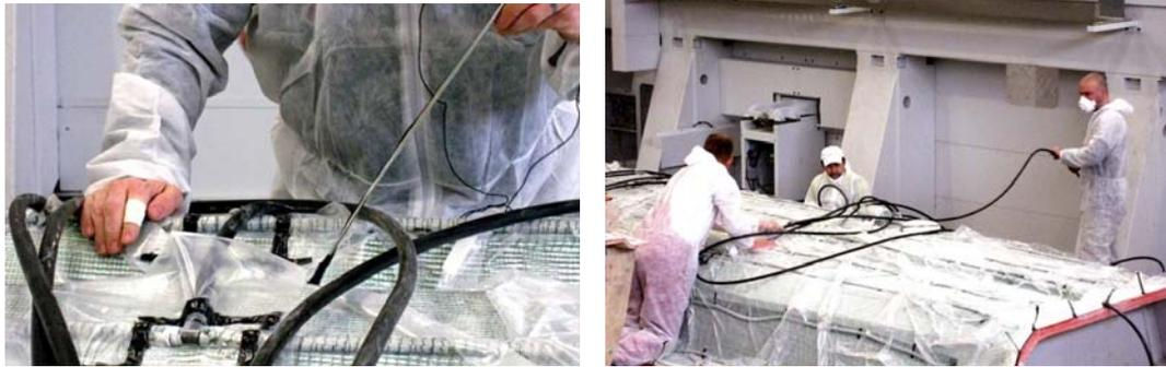
**Ilustración 72: preparación de los tubos para introducir la resina**
