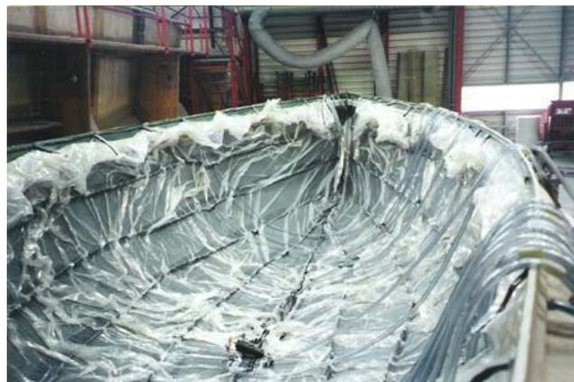
**Ilustración 75: laminado bajo vacío**
