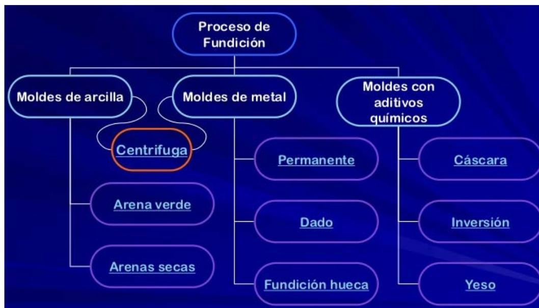
Ilustración 84: procesos de fundición.
