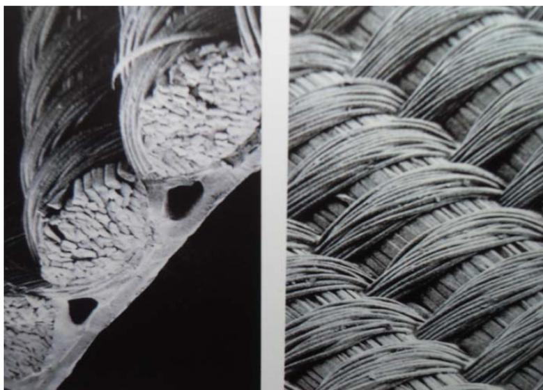
**Ilustración 103:** a la izquierda, una sección transversal de un laminado de Kevlar/ Dacrón aumentado 80 veces. La película y la cola se hayan bajo el sustrato textil. A la derecha, se observan los hilos de la urdimbre de Kevlar en este laminado de cortes verticales. Los hilos de la trama de Dácron únicamente se mantienen alineados.
