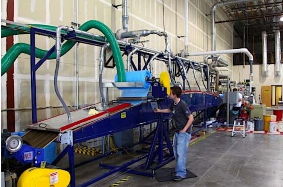
**Ilustración 142: máquina para esparcir las fibras 3**
