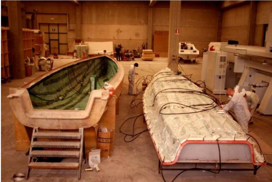
**Ilustración 74: moldes preparados para el proceso**
