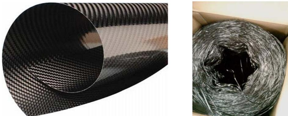
**Ilustración 54:** fibras de carbono
