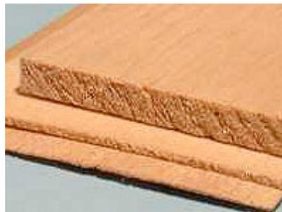
Ilustración 60: madera de balsa para núcleo
