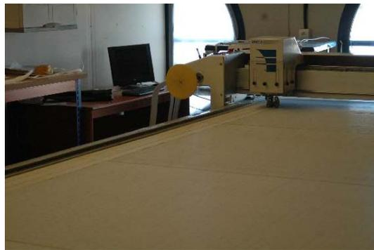
**Ilustración 108: corte computarizado, se cortan paños de forma automática.**
