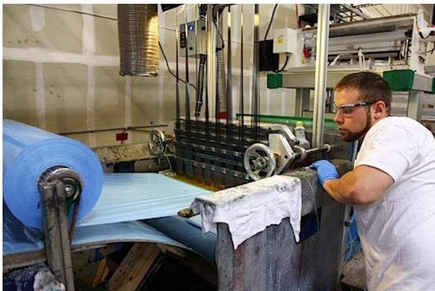
Ilustración 140: máquina para esparcir las fibras
