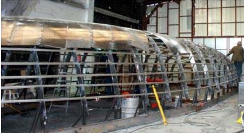
**Ilustración 40: soldadura de los forros.**
