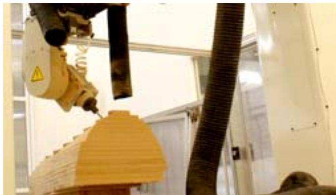
Ilustración 86: fresadora de 5 ejes trabajando
