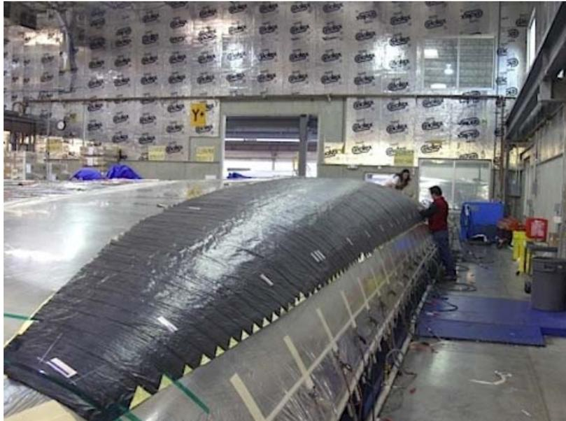
**Ilustración 146:** 3Di dispuesta sobre el molde.
