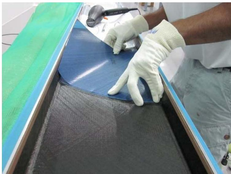
**Ilustración 88: Operario colocando fibra carbono en molde hembra**
