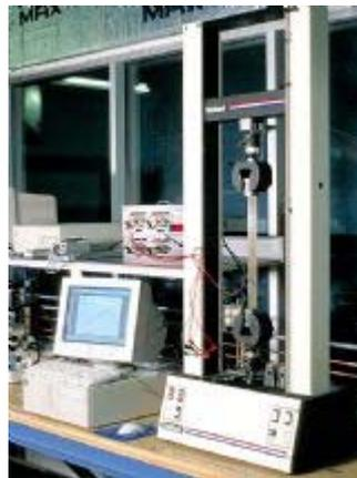
**Ilustración 124: ensayo de estiramiento de la tela**
