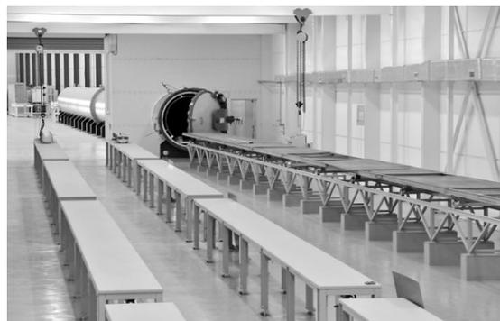
**Ilustración 90: molde macho en horno y horno para mástiles**
