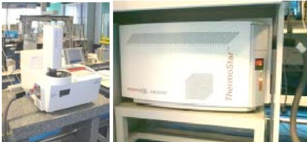
*Figura 16: Analizador termogravimétrico (TGA/DSC) Mettler Toledo "1HT" acoplado a un espectrómetro de masas cuadrípolo Balzers "ThermoStar QMS 300M3".*
