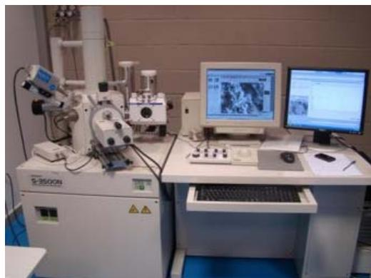
Figura 12: Microscopio electrónico Hitachi S-3500N.
