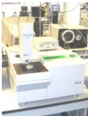
*Figura 14: Equipo de calorimetría diferencial de barrido (DSC), Mettler Toledo, modelo “DSC 822E”.*
