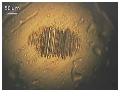
Figura 3.9. Micrografía óptica de la huella de desgaste de la bola de acero (AM, 25°C).
