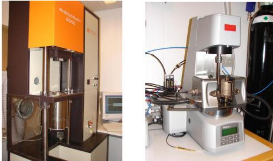
*Fig. 3.1.2 Reómetro capilar y rotacional, respectivamente, usados en mediciones.*
