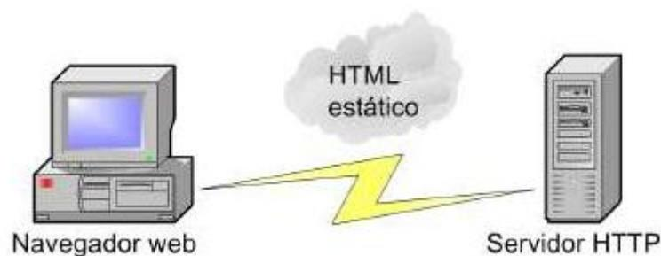
**Figura 2.2** Configuración de una aplicación Web con HTML estático
